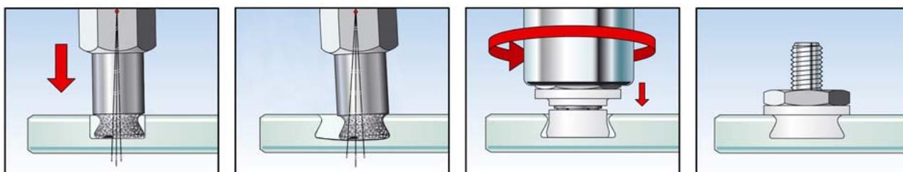
Perforazione e procedura di impostazione di ancoraggio per il point holder FZP-GZ nel vetro
