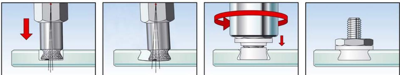
Forage et procédure de réglage du point d'ancrage pour le point holder FZP-GZ en verre
