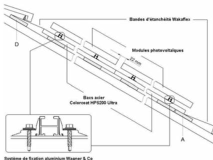
Section transversale du système de fixation
