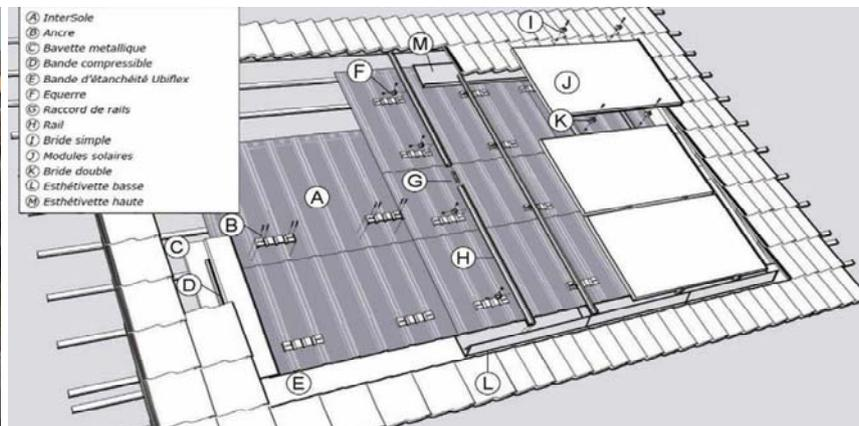
Dettagli del sistema di fissaggio
